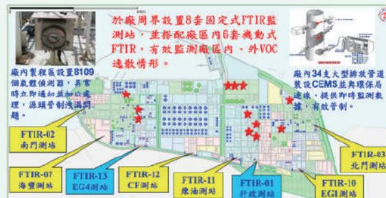
1. 於廠周界設置 8 套固定式傅立葉轉換紅外線光譜儀 (Fourier-transform infrared spectroscopy, FTIR) 監測站，並搭配廠區內 6 套機動式 FTIR，有效監測廠區內、外 VOC 逸散情形
